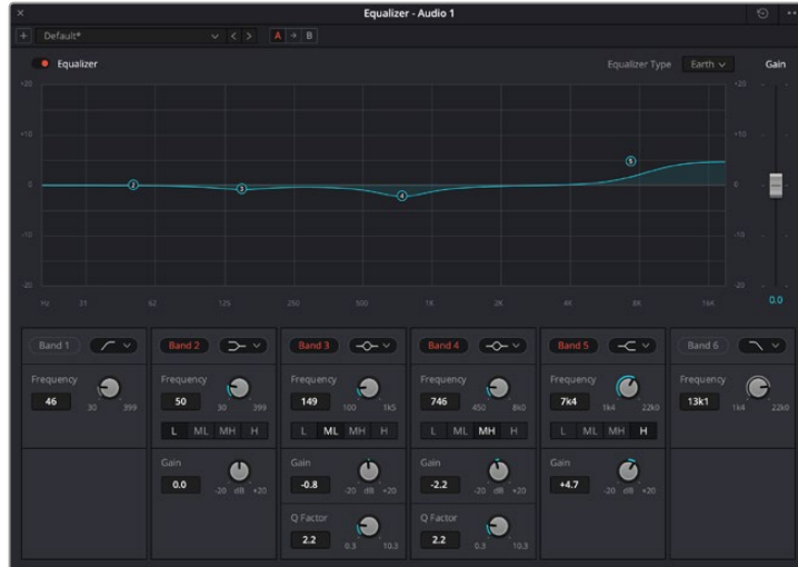
Her kanala uygulanabilen 6 bant parametrik ekolayzer
