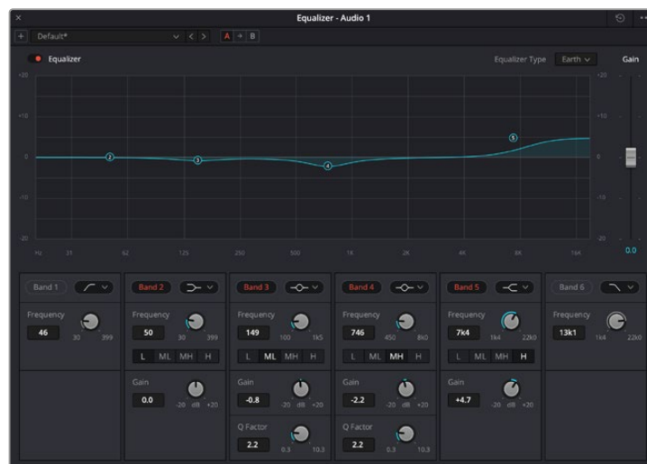
Equalizador paramétrico de 6 bandas que pode ser aplicado a todas as trilhas.
