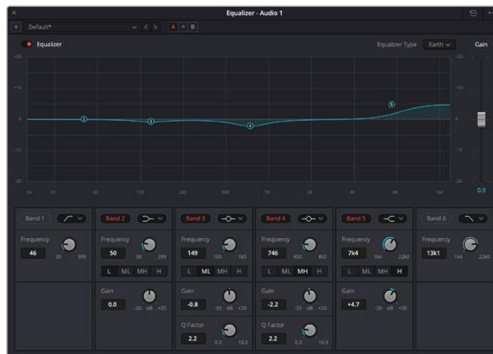
Parametrischer 6-Band-Equalizer, der auf jeden Clip angewendet werden kann
