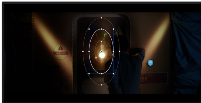
파워 윈도우를 사용하여 HSL 퀴리파이어 세컨더리 조절 기능을 사용하고 싶지 않은 영역을 숨길 수 있습니다.
