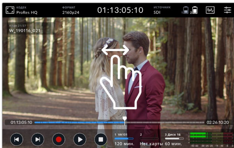
Движением пальца в горизонтальном направлении можно выполнять протяжку вперед или назад
