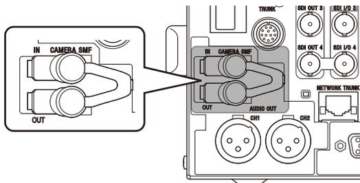
CAMERA SMF IN端子でカメラから映像信号、オーディオ (MIC) 信号、HD-TRUNK信号、NETWORK TRUNK信号を入力します。
