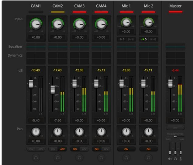
Cam 1のオーディオメーターは、グレーになっています。これは、「ON」または「AFV」のチェックボックスが有効になっていないため、オーディオが使用されないことを示していますが、Cam 2はAFVが選択されていますが、タリーライトが薄暗い黄色になっていることで分かるように、現在オンエアされていないためオーディオも使用されていません。Cam 3およびCam 4はダイレクトミックスが「ON」になっているので、他のカメラがオンエアされているとしてもCam 3とCam 4のミックスオーディオは常に使用されており、タリーライトが点灯しています。Mic 1とMic 2のオーディオレベルメーターは、これらの入力にオーディオが存在しないことを示しています。
