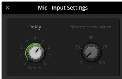
遅延コントロールをクリックして、左右に回すとアナログ入力に適用される遅延の量が増減
