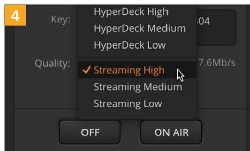
配信の品質をLow (低)、Medium (中)、High (高) から選択します。これにより、USB-C経由の収録用出力の品質も設定されます。
