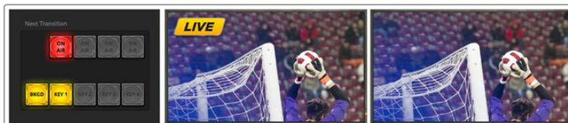
キーは様々な方法でプログラム出力にトランジションできます。キーはカットによるオン/オフ、ミックスによるオン/オフ、またはバックグラウンドのトランジションと同時のミックスなどが可能です。アップストリームキーは、ネクスト・トランジションコントロールを使用してプログラム出力へトランジションします。ダウンストリームキーのトランジションには、それぞれ専用のトランジションボタンを使用するか、または「DSK TIE」ボタンを使用してトランジションをメインのトランジションとリンクさせることもできます。
