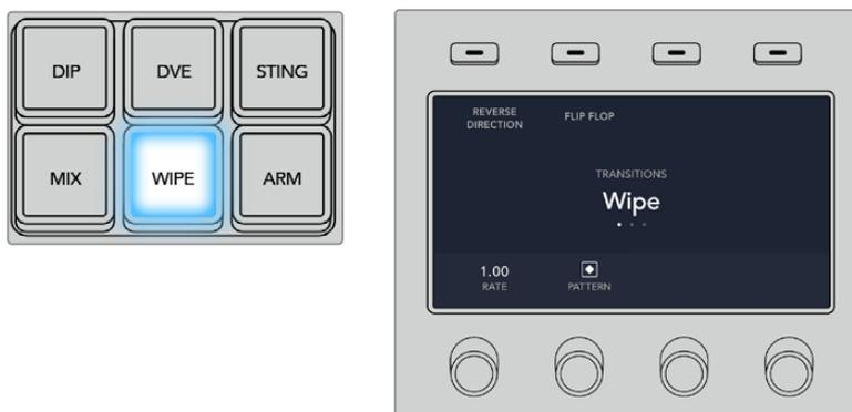
ソース選択列でソースボタンを押し、ワイプボーダーのソースを選択。「SHIFT」ボタンを長押しすると、カラージェネレーター、メディアプレーヤーなどのシフトソースが選択できます。
