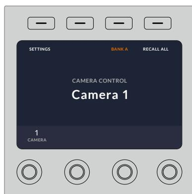
カメラバンクの選択、全カメラへのシーンファイルの呼び出しなどの機能に、ホームスクリーンから常にアクセス可能。
