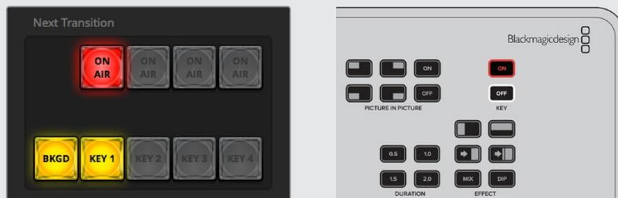
LCDメニューで「オンエア」設定を変更すると、ATEM Software Controlの「ON AIR」ネクスト・トランジションボタンも変わります。
