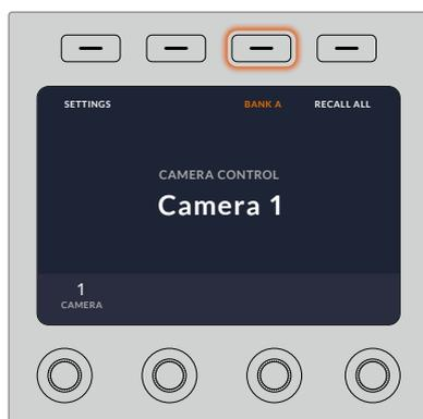
「バンク」ソフトボタンでバンクAとバンクBを切り替えるか、あるいは長押ししてカメラバンクを無効/有効にします。
