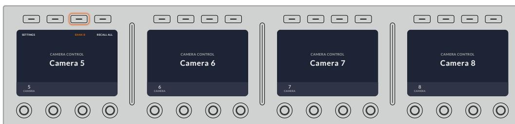
バンク設定は、2つのバンクでそれぞれ4つのCCUにカメラを割り当て、「バンク」ソフトボタンを押すだけで2つのバンクを即座に切り替えます。
