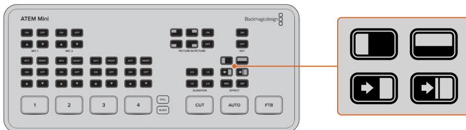
ランジションタイプのボタンを押して、縦方向/横方向のワイプ、プッシュ/スクイーズDVE、ミックス、ディップなど、使用するランジションを選択。
