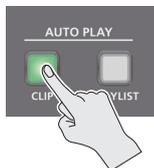
リプレイ側への出力切り替えを伴い、クリップが再生されます。クリップの再生が終了すると、出力 (OUTPUT SW) は再生前の状態 (ライブ・イン/リプレイ) に自動的に戻ります。
