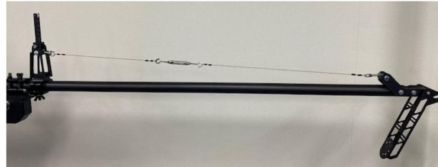
9)「ワイヤーリールベース④」のワイヤーを「ワイヤーテンション金具⑤」上部滑車(緑丸)へ通し、「雲台取付ステー⑥」の上部貫通ネジに取付け(青丸)
