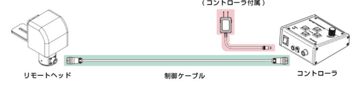
雲台本体と専用コントローラを1本のケーブルで接続するだけの簡単接続
