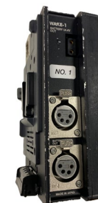
DC電源 ターミナル
